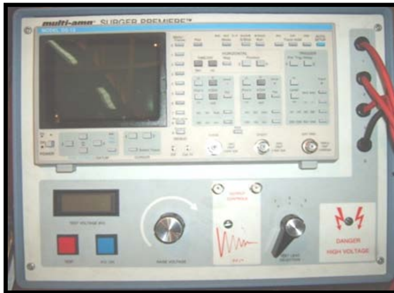
Figura IV.2. Imagen frontal del Generador de Pulsos.
